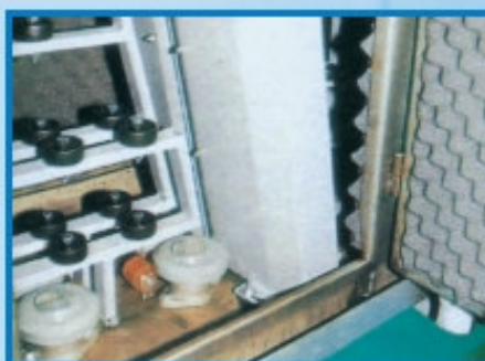
Ventilatore alta pressione con filtro e box insonorizzato, spugna afona all'interno della macchina; carter di protezione. High pressure ventilator with filter and noise reduction system inside the machine as well as for the ventilator; two-point glass guiding and protection bars.
