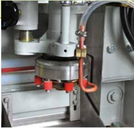
**ITALY** Un dispositivo (composto da un mandrino per lato) all'uscita della macchina, permette di smussare gli angoli della lastra di vetro. Il suo funzionamento è pneumatico, e controllato dal PLC (OPTIONAL).
