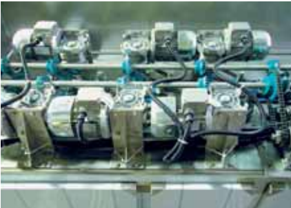
Obenliegender Antrieb für Bürsten und Glastransport, ein Motor pro Bürste bzw. pro Bürstenpaar (bei geschlossener Bauweise).
