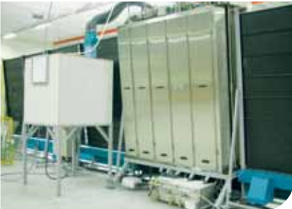
Verstärkter Ventilator in Schallschluckbox mit Luftfilter, einfacher Wartungszugang auch an der Rückseite der Maschine.
